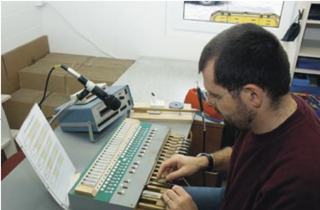
Edgar Ott bearbeitet die Stimmen, baut diese ein und erst dann wird das Instrument feingestimmt. Edgar Ott prépare les voix, les monte et ensuite seulement l'instrument est accordé avec précision.
